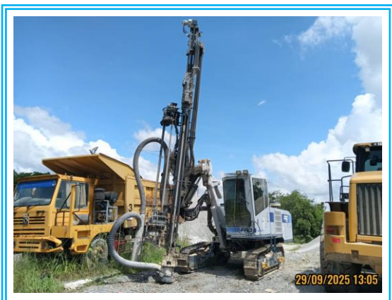
รูปที่ 3-3 เครื่องเจาะระเบิดที่มีอุปกรณ์เก็บฝุ่นติดไว้กับหัวเจาะ
